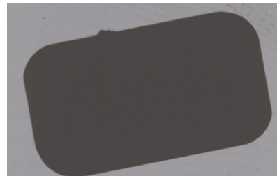
图3 上轮廓存在凸点的方片
