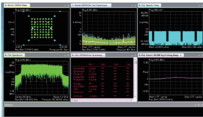
图11 89600 VSA软件屏幕快照显示了解调OFDM信号的多个视图
