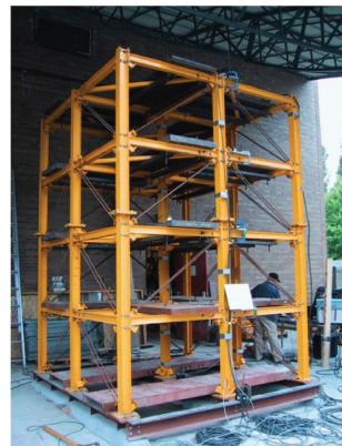
图 14 IASC-ASCE Benchmark II 结构
