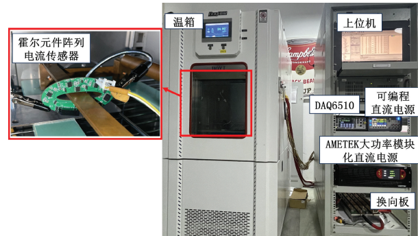
(b) 实验装置实物
