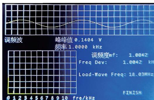
图 19  $m_f=1$  时，调频波的主要测量参数
