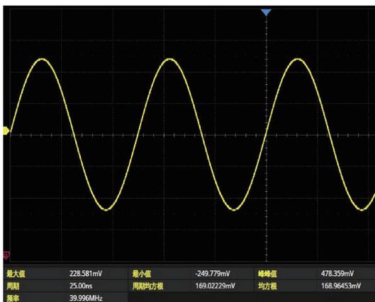
图4 40 MHz 本振信号的时域波形
