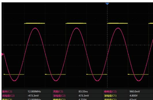
图7 锁相环锁定时的波形
