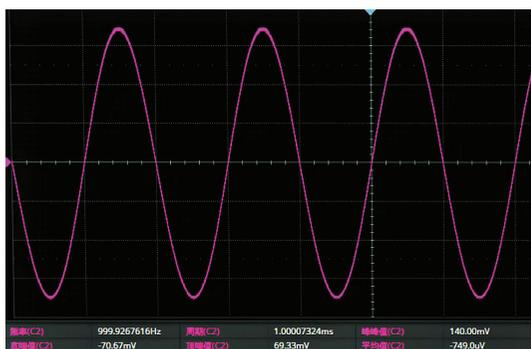
图 17  $m_f=1$  的调频波解调波形
