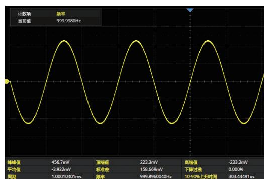
图 11  $m_a = 0.2$  的调幅波解调波形
