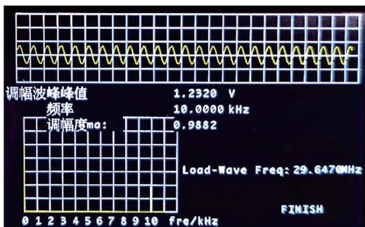
图 14  $m_a=1$  时, 调幅波的主要测量参数
