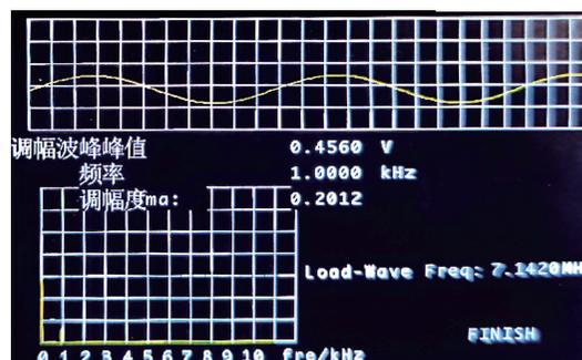
图 13  $m_a = 0.2$  时,调幅波的主要测量参数
