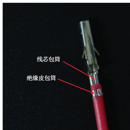
图 1 线束端子正确压接图
