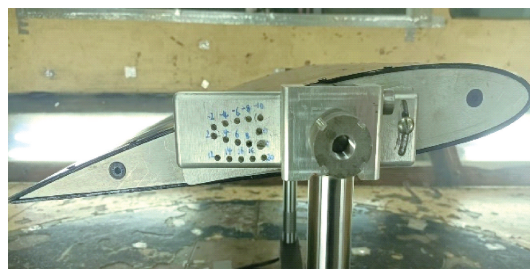
图3 模型俯仰角调节机构
