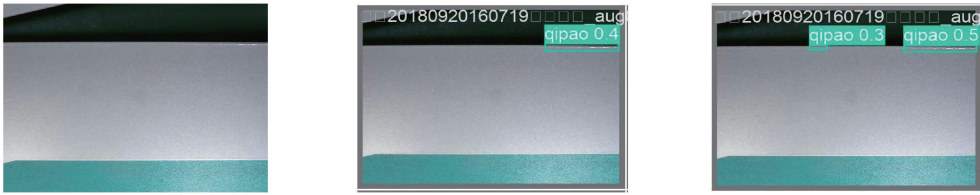
图15 该图中有两个漆泡缺陷
