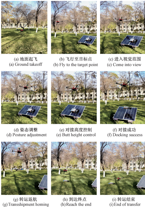
图 10 归中对接平台转运实验
