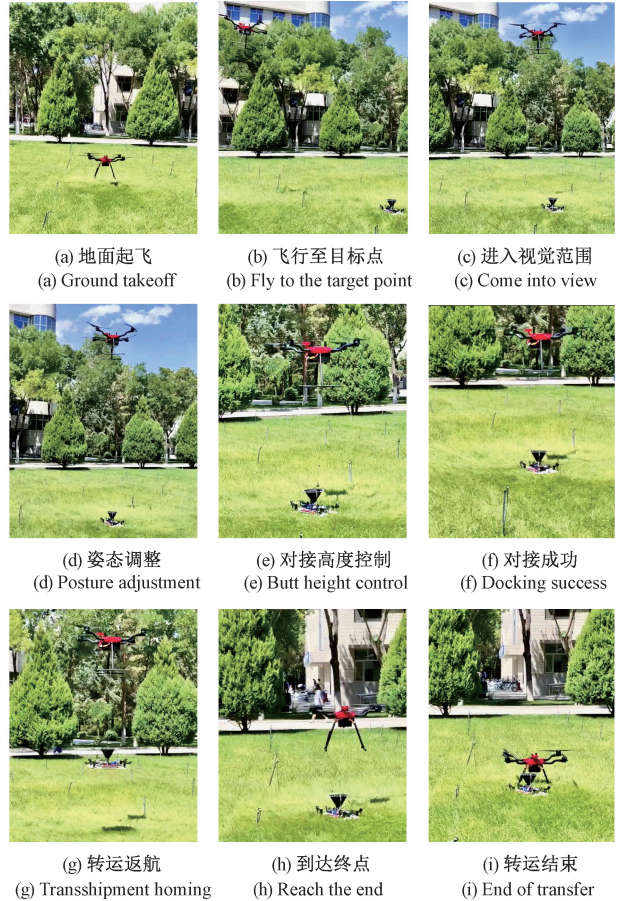
图 9 锥型对接平台转运实验
