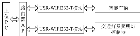
图 2 USR-WIFI232-T 的 STA 组网结构
