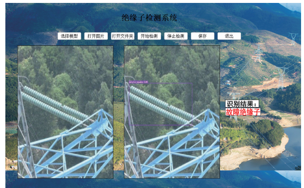
图 10 自爆绝缘子检测系统
